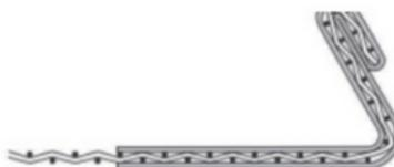
Borde metálico de doble pliegue
