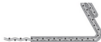
Borde metálico de doble pliegue
